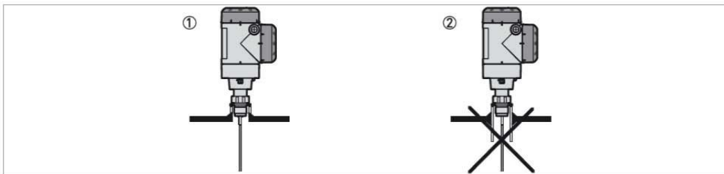
图 8-17: 用于螺纹过程连接件的焊接底座
